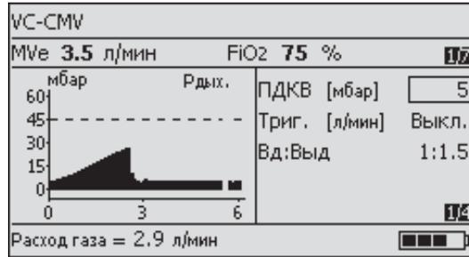
Оставшийся заряд батареи Oxylog 3000 plus отображает в виде отрезков по 25 % в правом нижнем углу окна информации при включенном питании.
