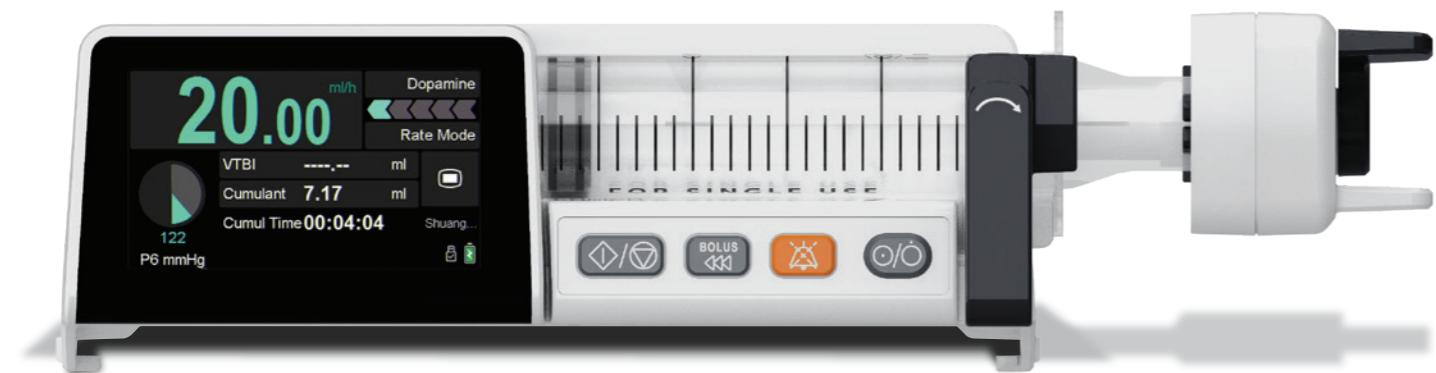
Последнее мастерство IML не оставляет щелей между панелью экрана и корпусом, предотвращая попадание жидкостей.
